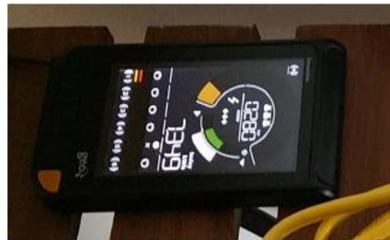
Il sistema prevede la misura on line, ogni quarto d’ora, di sei tecnologie elettriche di uso comune: il boiler, il frigorifero, la lavatrice, il forno, la postazione PC e la TV. Il sistema, inoltre, consente di **misurare il consumo totale dell’abitazione**, in modo da ricavare così per differenza i consumi dei restanti elettrodomestici.
